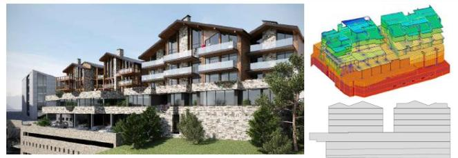
Modélisation, dimensionnement et analyse sismiques d'un centre commercial avec habitations et 3 niveaux de parkings
