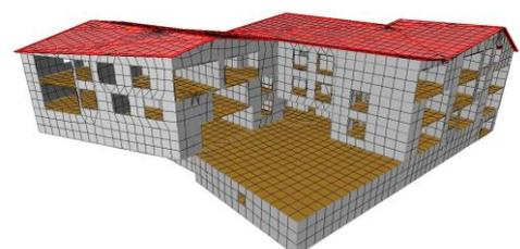
Modélisation, dimensionnement et analyse sismique d'un bâtiment à Vouvy
